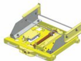
Rys. 2.6. Człon wysuwny typu kasetowego do BADANIA IZOLACJI KABLI
